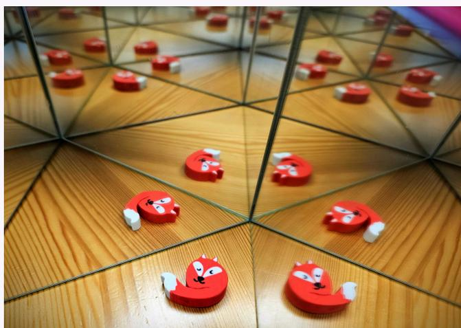
La fotografía de arriba muestra una configuración física de la disposición de los espejos  $(60^\circ, 60^\circ, 60^\circ)$ , un triángulo equilátero formado por los tres espejos. La captura de pantalla siguiente es la demostración virtual que representa un triángulo isósceles en ángulo recto para la disposición del caleidoscopio  $(90^\circ, 45^\circ, 45^\circ)$ , similar a la configuración del espejo del módulo Flores de Primavera.
